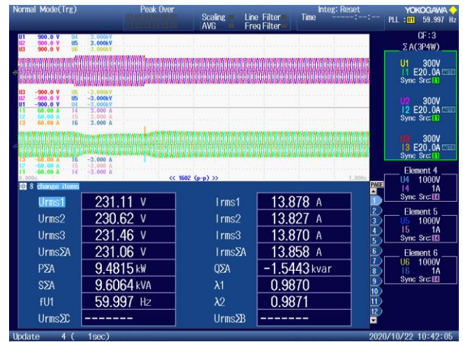
Fig. 17. High Voltage Ride Through 제어 기능 시험 결과.
