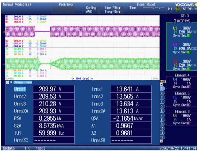
Fig. 16. Low Voltage Ride Through 제어 기능 시험 결과.
