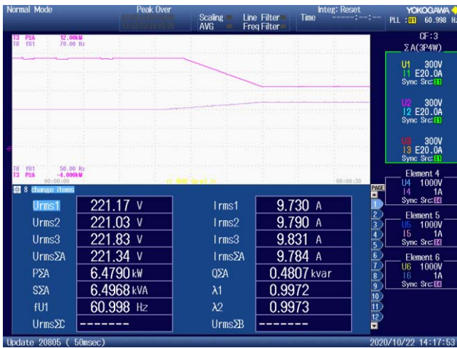
Fig. 15. Frequency-Watt 제어 기능 시험 결과.
