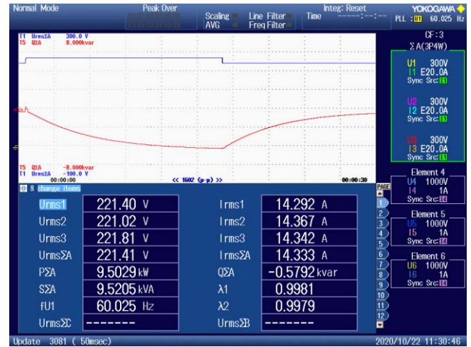
Fig. 9. 연계점 전압이 1.04 [PU]일 때, Volt-Var 제어 시험 결과.
