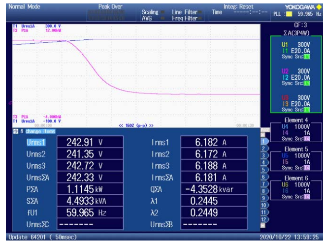
Fig. 13. Volt-Watt 제어 기능 시험 결과.
