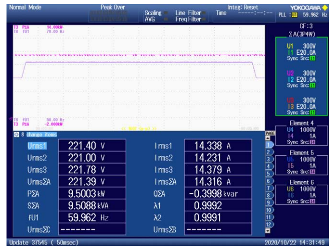
Fig. 18. High Frequency Ride Through 기능 시험 결과.
