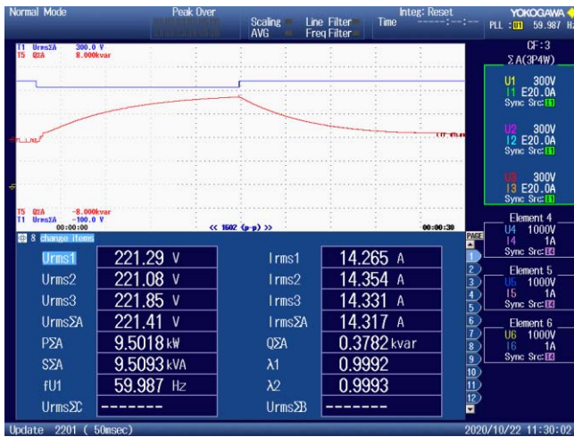
Fig. 8. 연계점 전압이 0.96 [PU]일 때, Volt-Var 제어 시험 결과.
