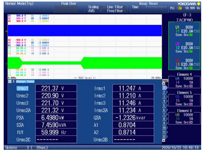
Fig. 5. 유효전력 출력제한 기능 시험(100% to 20% 제한).
