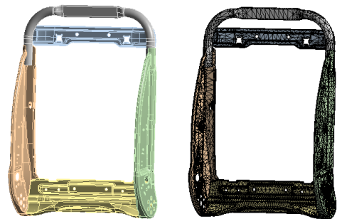
[그림 3] 시트 백 프레임의 모델 형상과 메시 형상 [Fig. 3] Configuration of model and mesh of seat back frame
