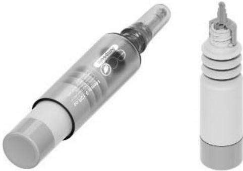
올레핀 재질의 벨로우 일체형 리필 앰플 용기로 펌프 없이도 정량 토출이 이뤄진다는 장점을 지녔다. 내용기와 벨로우 형상의 결합과 올레핀 계열의 부드러운 물성을 통해 기존 금속 스프링 대체해 부품수를 줄였으며 기존 금속 스프링 디스펜서와 동일한 부드러운 누름 감도를 구현했다. 드로퍼 피펫 디자인과 오리피스 구조의 적용으로 Drop by Drop 내용물 토출이 가능하고 단일 계열 소재로 분리배출 및 100% 재활용을 할 수 있다. 간단한 스크루 방식의 내용기 리필을 적용했다.
