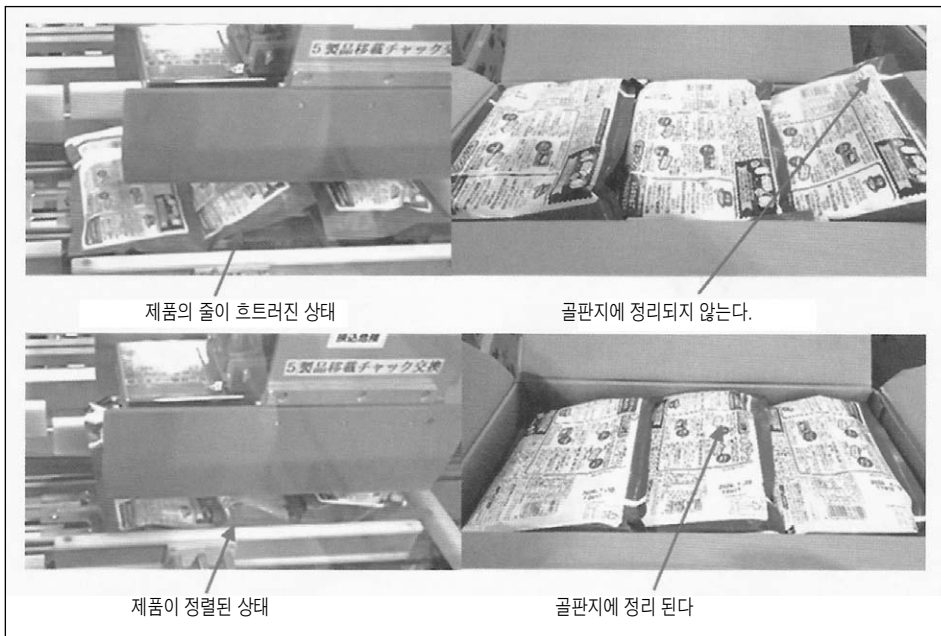
[그림 5] 골판지로의 제품 충전 상태 (위: 장치 개조 전, 아래: 장치 개조 후)
