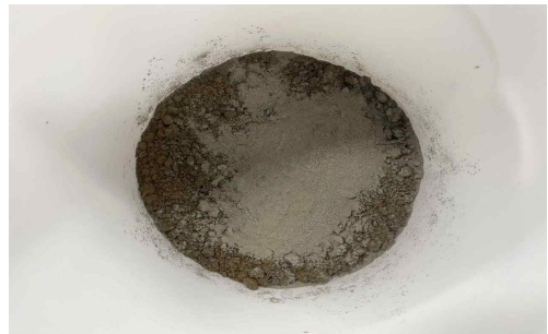
그림 7. 원지반토 및 지반안정제 혼합 Figure 7. Mixing of soil stabilizer and in-situ soil
