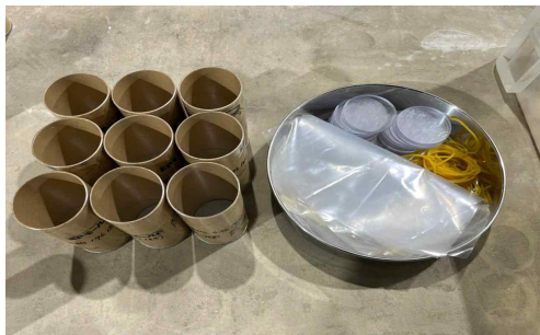
그림 5. 1회용 몰드 및 캡 Figure 2. Disposable molds and cap
