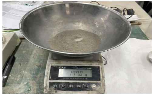
그림 6. 지반안정제 계량 Figure 6. Measurement of soil stabilizer
