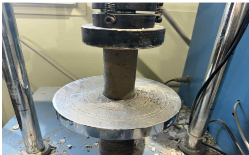
그림 11. 양생일별 일축압축강도 측정 Figure 11. Unconfined compressive strength measurement by curing date
