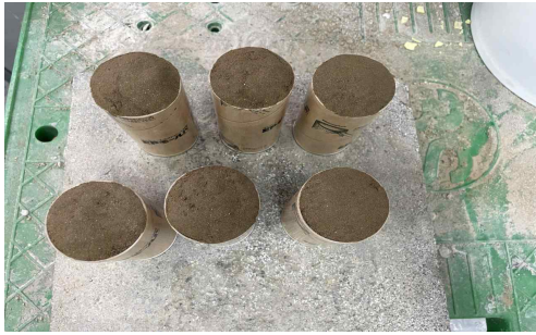
그림 10. 일축압축강도시료 제작 완료 Figure 10. Completed making of unconfined compressive strength specimen
