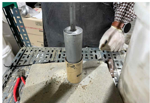
그림 9. 혼합토 다짐 실시 Figure 9. Compaction of mixture soil
