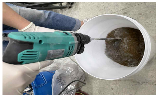
그림 8. 혼합믹서를 이용한 혼합토 제작 Figure 8. Mixing process using mixing equipment
