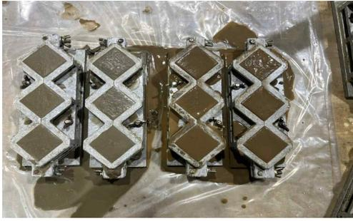
그림 6. 호모겔 압축강도 시료 제작 완료
