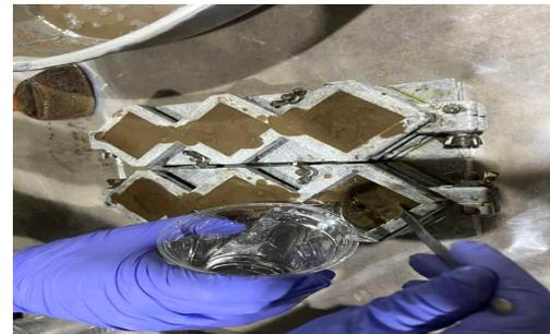
그림 5. 호모겔 압축강도 시료 제작 과정
