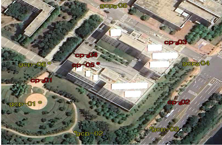
그림 5. 지상기준점(GCP) 및 점검점(CP) 위치
