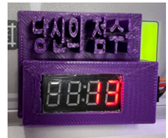
(d) Display exterior made with 3D printer
