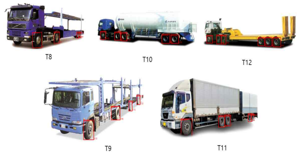
그림 5. 트레일러 바퀴 검출 사례 Fig. 5. The examples of wheel detection
