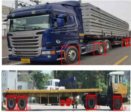
그림 6. 트레일러 바퀴 검출의 잘못된 사례 Fig. 6. Examples of incorrect trailer wheel detection
