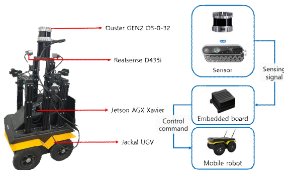
그림 3. 데이터 취득을 위한 모바일 로봇 구성 Fig. 3. Configuration of mobile robot for acquiring dataset
