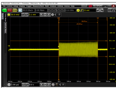
그림 10. 20usec 송신 첩 펄스 파형 Fig. 10. 20 usec transmitter chirp pulse waveform
