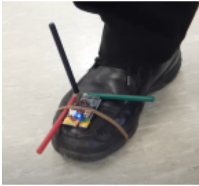
Fig. 1. 발등에 설치된 IMU 센서 [6]
