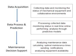
그림 1. 예측 유지관리 시스템의 통합 구조 Fig.1. Overall structure of a predictive maintenance system
