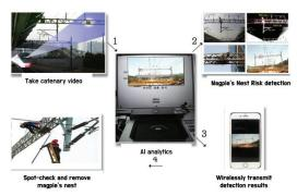
그림 3. 실시간 전차선 까치집 감지 시스템 Fig 3. Automated real-time magpie detection system for streetcar tracks
