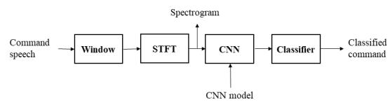
그림 4. CNN 명령어 분류시스템
