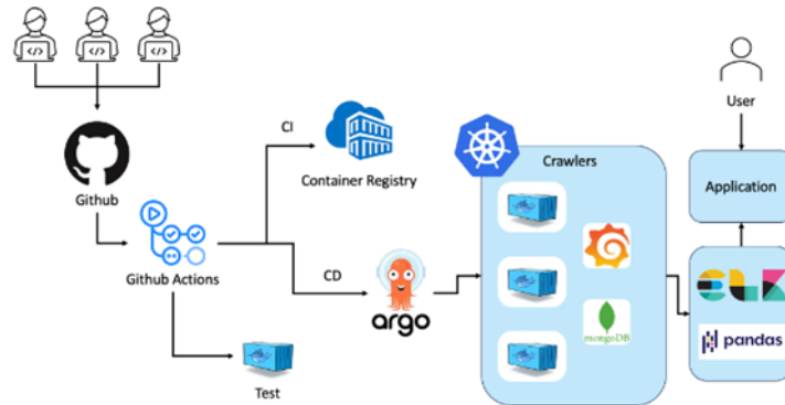
Figure 2. Improved large-scale data collection automation system 그림 2. 대규모 데이터 수집 자동화 시스템 개선
