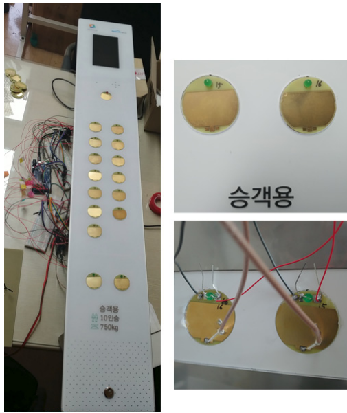
Fig. 7. 16 Buttons installed on the elevator panel. 그림 7. 엘리베이터 패널에 16개의 버튼을 부착한 모습
