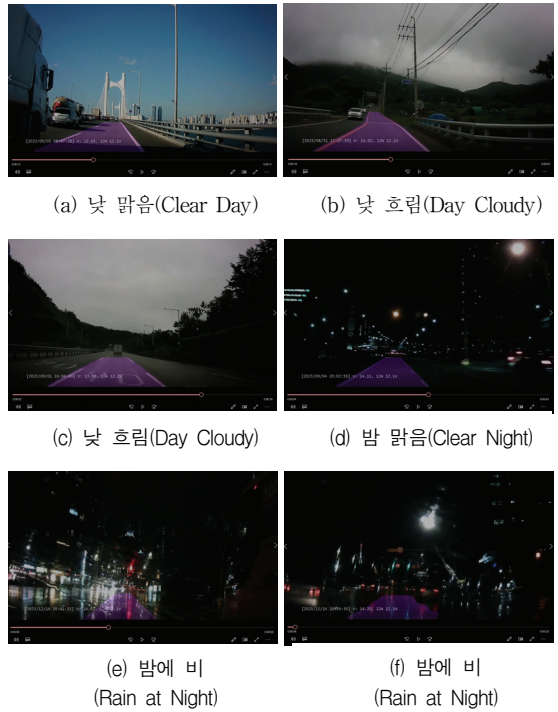
그림 2. 주행 가능한 도로 영역 추출 결과 Fig. 2 Drivable Road Area Extraction Results
