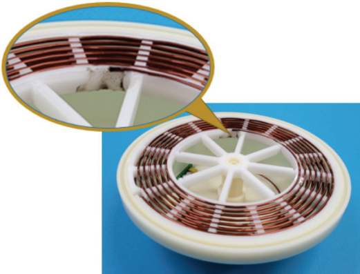
그림 4. 선간 방전에 의해 손상된 송전 공진코일 Fig. 4 Damaged transmitting resonance coil due to line-to-line discharge
