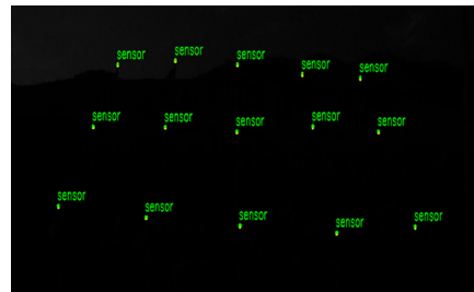
그림 9. 야간 LED Target 점등 검출-이미지 프로세싱
