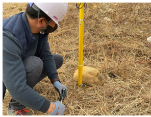
(a) 3방향 와이어를 통한 IoT 센서 장비 변위 발생
