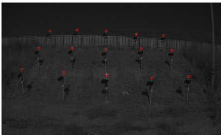
그림 8. 주간 LED Target(15개) 검출-YOLOX
