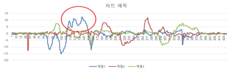
그림 10. F/T핸들러를 과하게 당기거나 밀 때 반발힘이 작용하는 모습 Fig. 10 Repulsive force waveforms in action when pulling or pushing the F/T handler too hard
