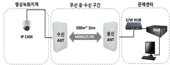
그림 4. 무선 영상녹화시스템
