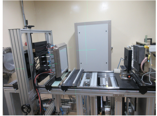
그림 5. 양성자 빔 조사 시험 셋업 Fig. 5. proton radiation test setup
