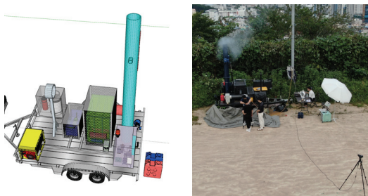
그림 1. 매연발생장치를 이용한 연기 사진 데이터의 구축 Fig. 1 Construction of Plume Photo Data using a Smoke Generator
