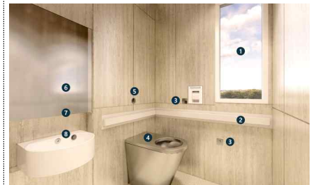
<화장실> ①창 ②안전바(결박방지) ③비상벨 ④변기(스테인레스) ⑤물내림 센서 ⑥거울(아크릴) ⑦거울장(수전, 비누, 핸드타올 매립) ⑧세면대(스테인레스)
