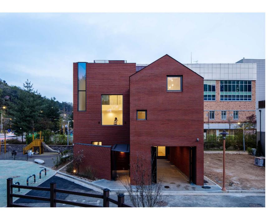
건축주 | 최정환 감리자 | 제이와이리액트 건축사사무소 시공사 | SPACE A&C 설계팀 | 안준희, 손지영 설계의도 구현 | 유하우스·유스페이스건축사사무소(주) 대지위치 | 경기도 시흥시 능곡중앙로 123-7 주요용도 | 단독주택 대지면적 | 232,00㎡ 건축면적 | 112,86m² 연면적 | 242,29㎡ 건폐율 | 48.65% 용적률 | 90.78% 규모 | 3F 구조 | 철근콘크리트구구조 **외부마감재 |** 치장벽돌(상산세라믹 레드토석), 칼라징크 내부마감재 | 석고보드 위 수성페인트, 원목마루, 포슬린타일
