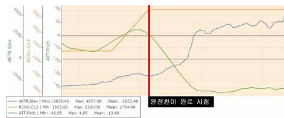
그림 4. 완전 Transition 이후의 비행 로그 Figure 4. Flight Log After Fully Transition
