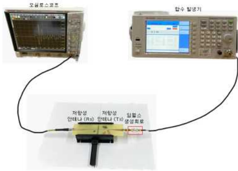
그림 4. 측정 장비 셋업 Fig. 4. Experimental setup; it consists of resistive antenna set(Transmitter, receiver) and impulse generator circuit.
