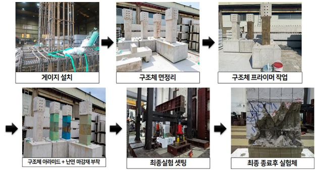
그림 2 내진보강 기둥 실험체 제작 과정
