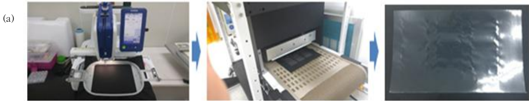
(a) 전도사를 자수하여 전극을 패턴화함 → MCNT 전도성 페이스트 스크린 프린트 → 나일론 혼용 원단 코팅
