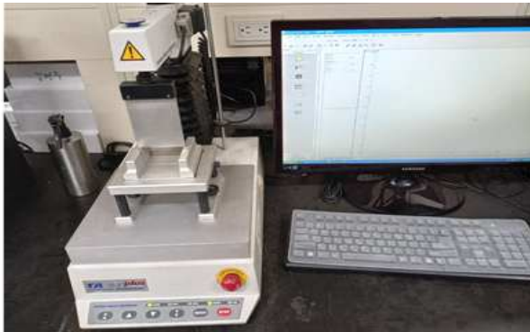
그림 1. 전단력 측정기(TA XT PLUS 모델) Figure 1. Shear force meter (TA XT PLUS model).
