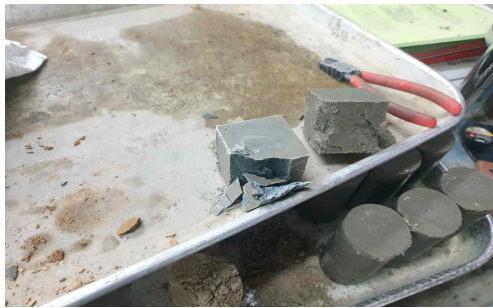
그림 6. 호모겔 압축강도 측정후 시료 전경 Figure 6. View of after measuring homogel compressive strength specimen
