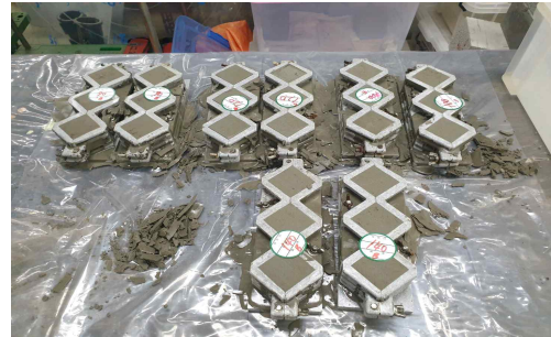
그림 4. 호모겔 압축강도 시료 제작 완료 Figure 4. Completed of homogel compressive strength specimen
