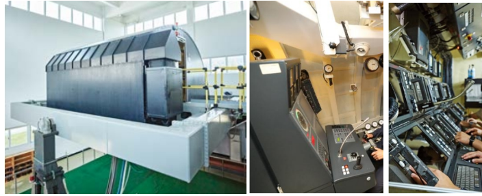
<그림 2 Submarine Training Simulator of Korean Navy, a) Motion Platform, b, c) Inside Instruments (출처 : 국방부 블로그, 국방일보)>
