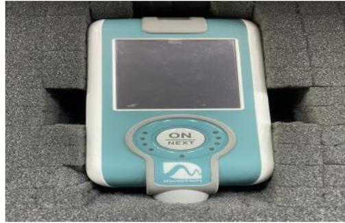
Fig. 3. Myotonometer(MyotonPro, Estonia)
