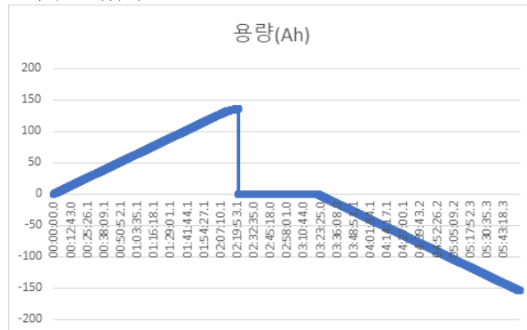
Figure 7. Battery capacity by time using full charge · discharge method(Kona 2) 그림 7. 완전 충·방전 방식을 적용한 시간대별 배터리 용량(코나 2)
