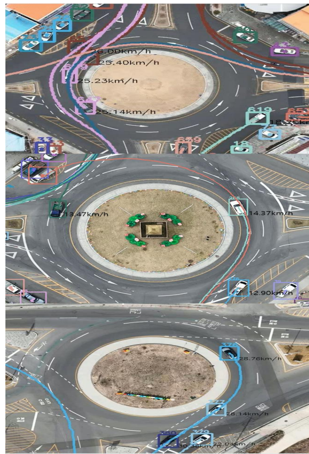
그림 8. 추적 결과 및 진입 속도 계산 표시 예시 Fig. 8. Examples of tracking results and entry speed visualization
