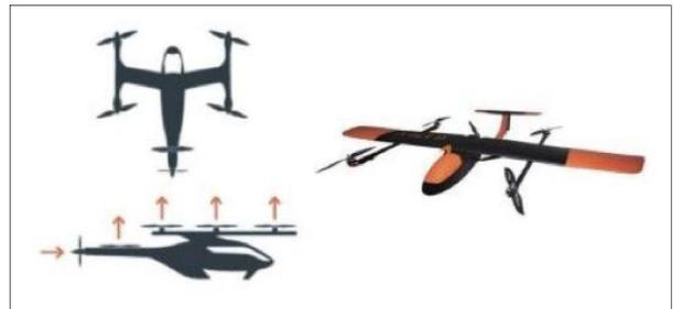
그림 2. Lift-cruise 형식 E-VTOL
