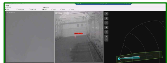
(그림 5-1) 실영상 카메라 객체 탐지 실패(좌), 열영상 카메라의 객체 탐지 성공(중양), 레이더 객체 탐지 성공(우)
