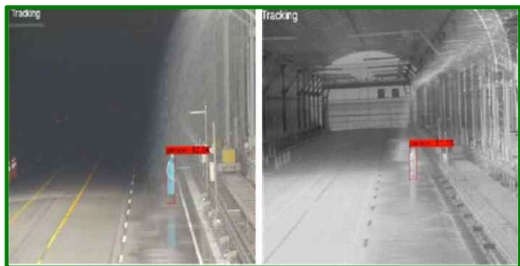
(그림 4-3) 실영상 카메라(좌) 및 열영상 카메라(우)의 객체 탐지 성공
