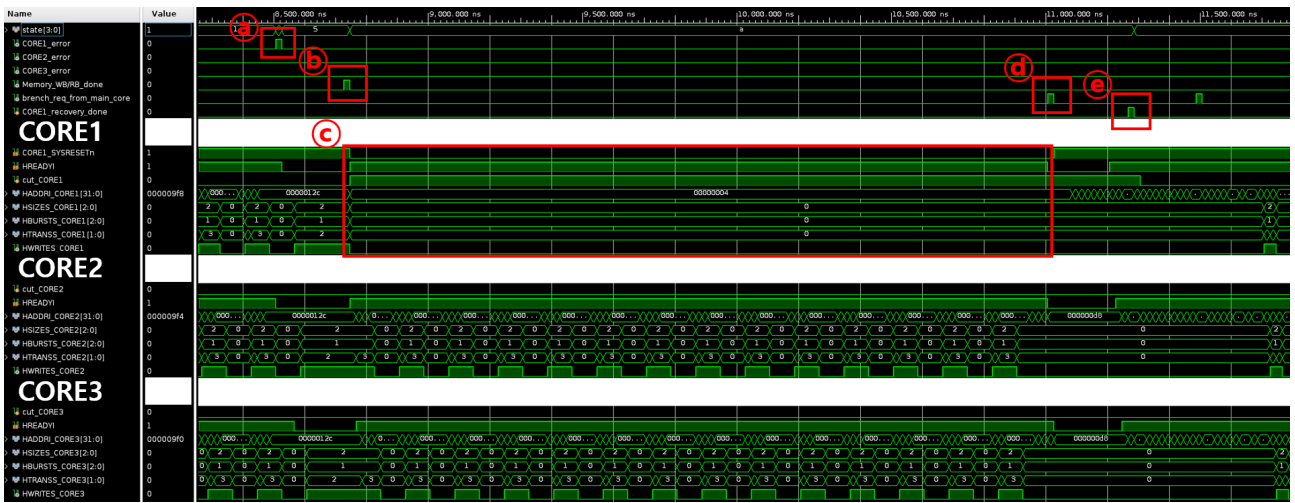
Fig. 4. Waveform of error occurrence and recovery process in CORE1. 그림 4. CORE1에서의 에러 발생 및 복구 과정 파형
