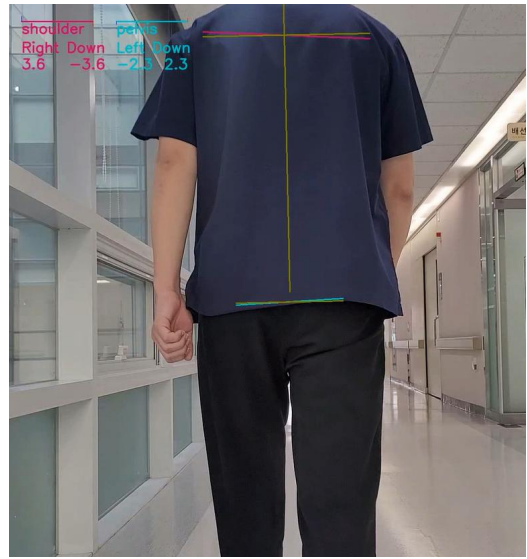
그림 16. 정면 영상의 보행 분석 시스템 결과 예시 Fig. 16. Demonstration of the gait analysis system on frontal video
