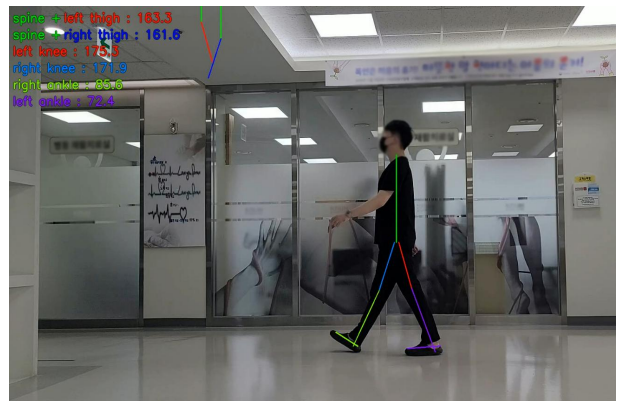
그림 17. 측면 영상의 보행 분석 시스템 결과 예시 Fig. 17. Demonstration of the gait analysis system on sagittal video
