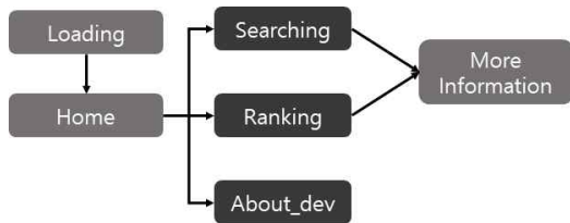
그림 5. 본 서비스의 모바일 애플리케이션 기능 구조도 Figure 5. Mobile application functional structure of this service
