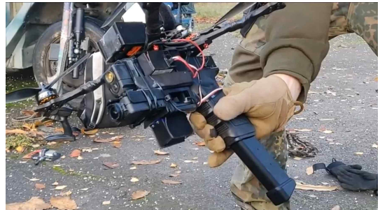
출처: https://youtu.be/NS1KFmFw2Dw 그림 12. 에어소프트 권총을 장착한 FPV드론 Figure 12. Airsoft gun mounted on FPV drone
