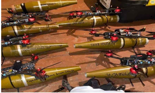
출처: https://dronexl.co/2023/02/01/ukraine-fpv-drones-rpg-7/ 그림 7. RPG-7 탄두를 탑재한 FPV드론 Figure 7. FPV drone with RPG-7 warhead
