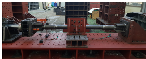
(d) BRB-EP Specimen Test Setup
