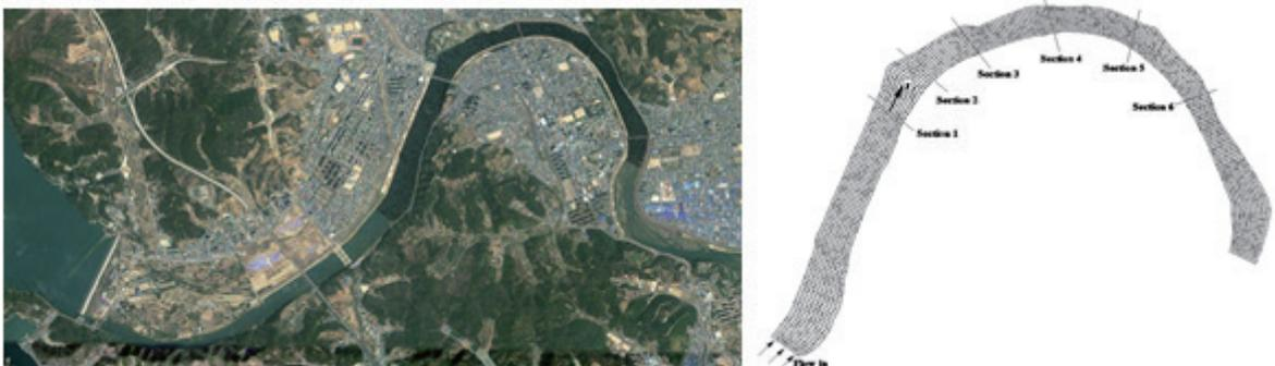
그림 7. 하천 흐름해석모형의 자연하천 적용 사례 (진주시 남강)
