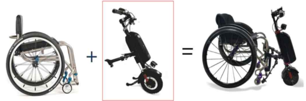
그림 1. 전방 휠체어 동력보조장치 Figure 1. Front power assist wheelchair
