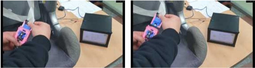
[그림 18] 안전벨트 체결 감지 기능 시험 모습: 체결(좌), 미체결(우)
