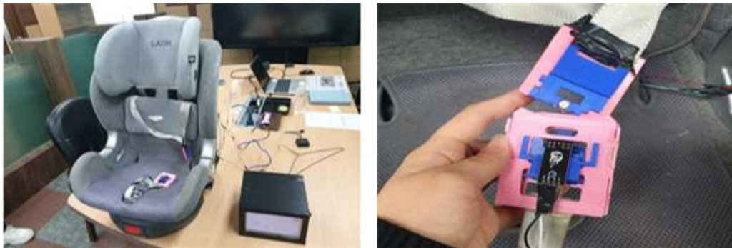
[그림 17] 개발한 스마트 카시트 시스템(좌)의 체결 감지 기능이 내장된 안전벨트(우)
