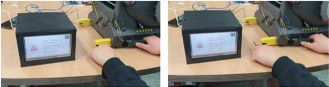
[그림 20] 아이소픽스 체결 감지 기능시험 모습 : 체결(좌), 미체결(우).
