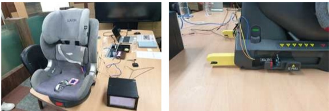
[그림 19] 개발한 스마트 카시트 시스템(좌)의 아이소픽스 체결 감지부(우)
