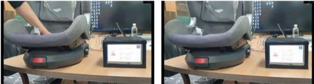
[그림 16] 개발 시스템(좌)의 착석 감지 기능시험 모습: 착석(좌), 미착석(우)
