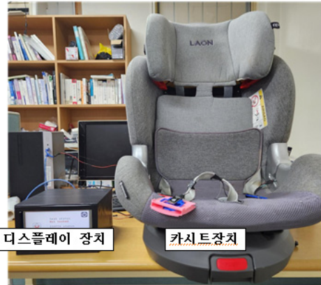
[그림 8] 개발한 스마트 카시트 시스템: 카시트 장치(우)와 디스플레이 장치(좌)
