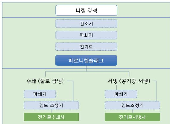
그림 6. 제조 공정별 페로니켈슬래그 잔골재의 제조공정
