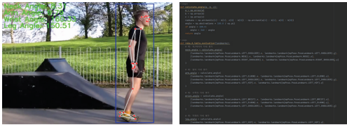
그림 2 관절 keypoint와 관절별 각도 계산 및 구현 알고리즘
