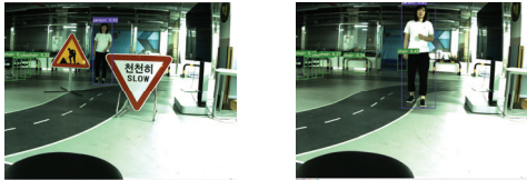
그림 6. YOLO7를 이용한 객체 인식 결과 Fig. 6 Object detection results using YOLO7
