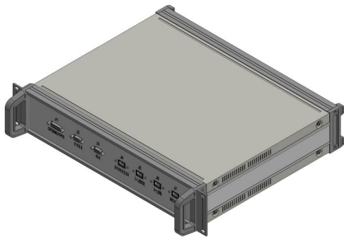
그림 5. 모의기 통신 보드 통합 모듈의 외부 형상 Fig. 5. The external shape of integrated synchronizing & real-time processing Module
