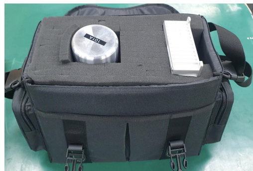
그림 4. 실측장비 (좌: TEPC, 우: Liulin) Fig. 4. measuring equipment(L: TEPC, R: Liulin)
